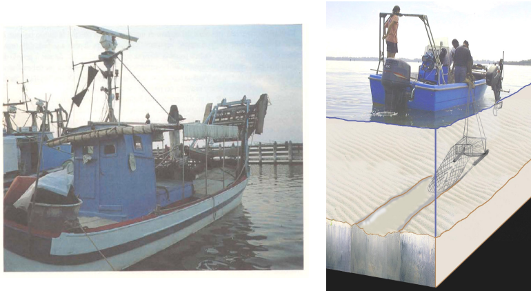
Figura 1.2 Imbarcazione attrezzata con draga idraulica (a sinistra) e rusca (a destra)
