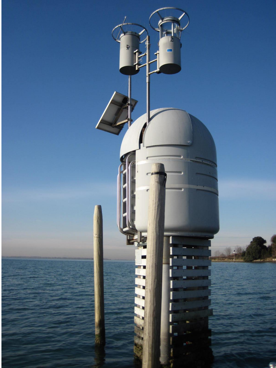
Figura 2. La stazione Ve-6 a Saccasessola con la coppia di deposimetri “bulk” per la raccolta delle ricadute atmosferiche.
