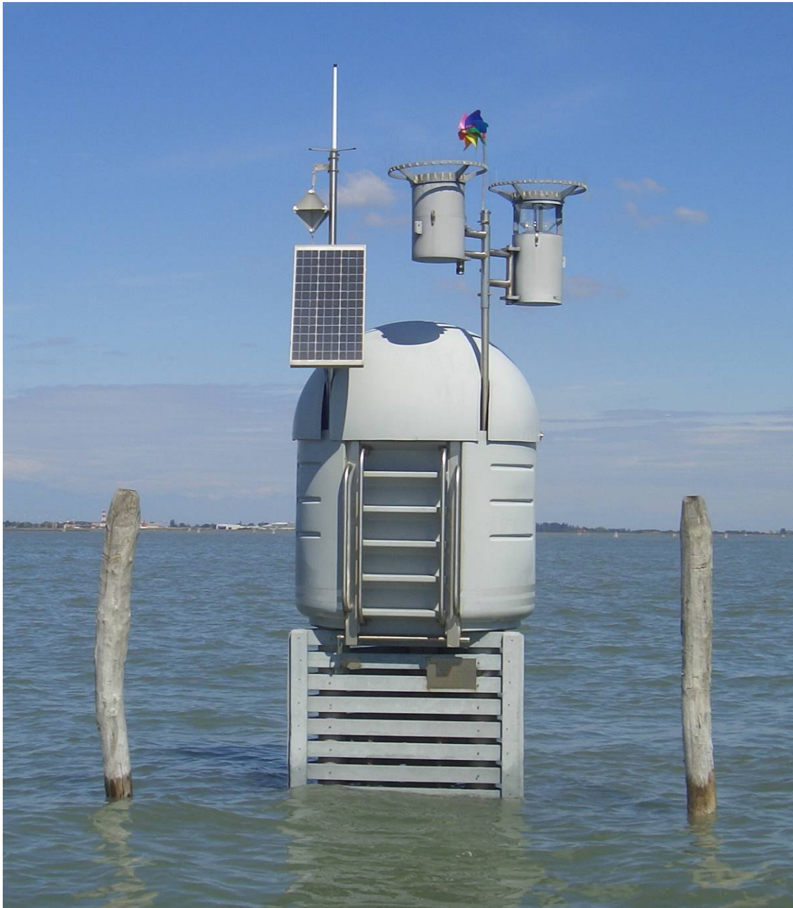
Figura 2. La stazione Ve-2 a Campalto con la coppia di deposimetri “bulk” per la raccolta delle ricadute atmosferiche
