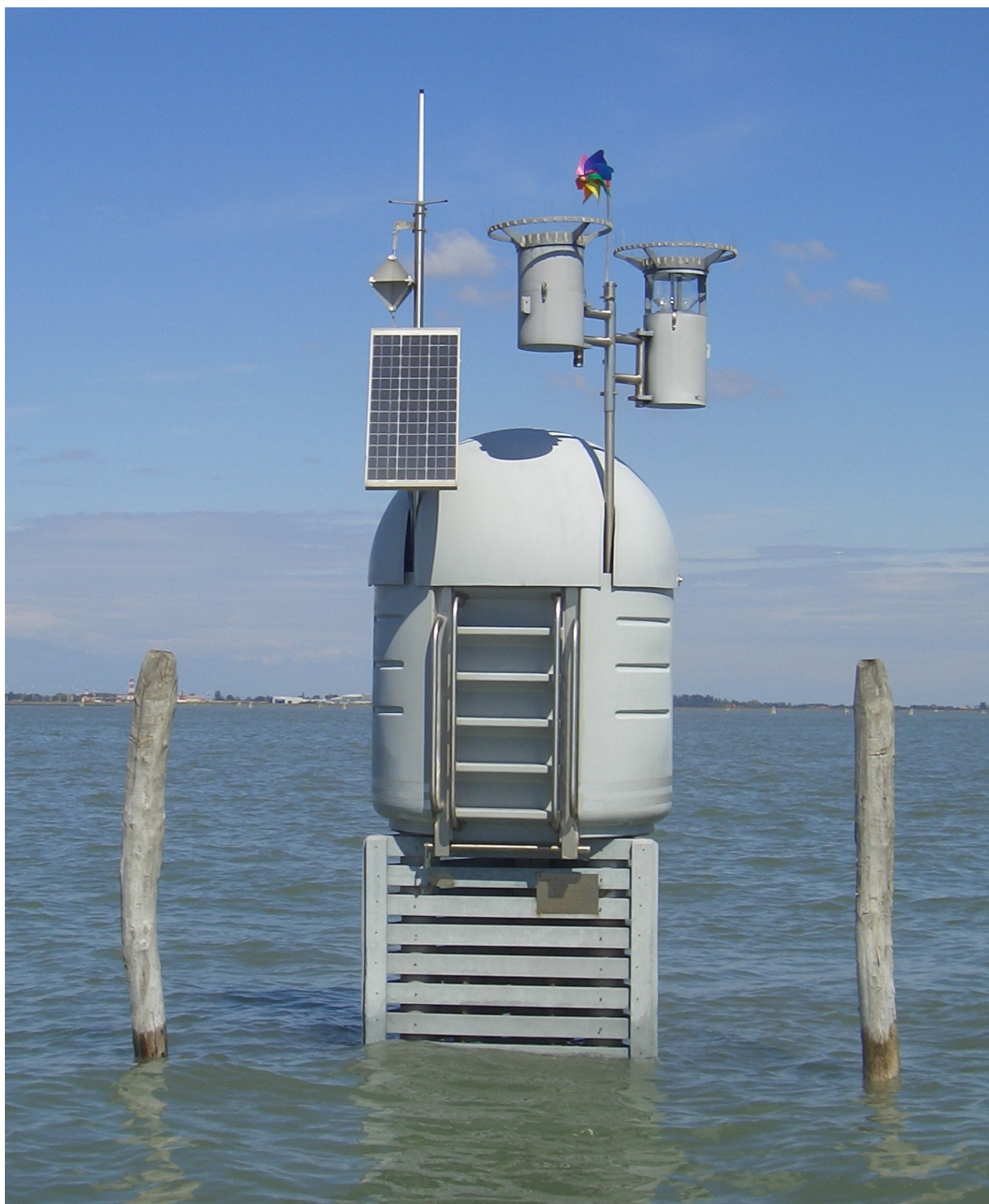
Figura 2. La stazione Ve-2 a Campalto con la coppia di deposimetri "bulk" per la raccolta delle ricadute atmosferiche
