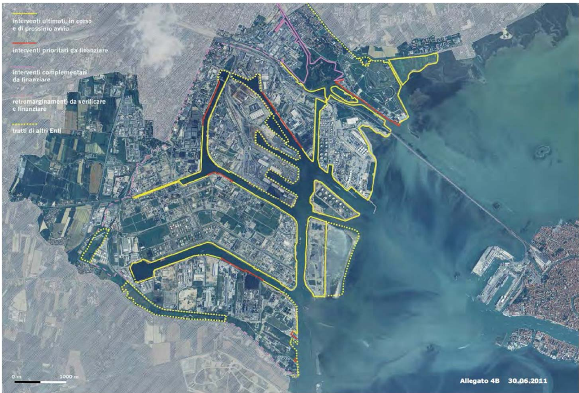
Figura 3 Stato d'avanzamento lavori dei marginamenti al 30.06.2011.
