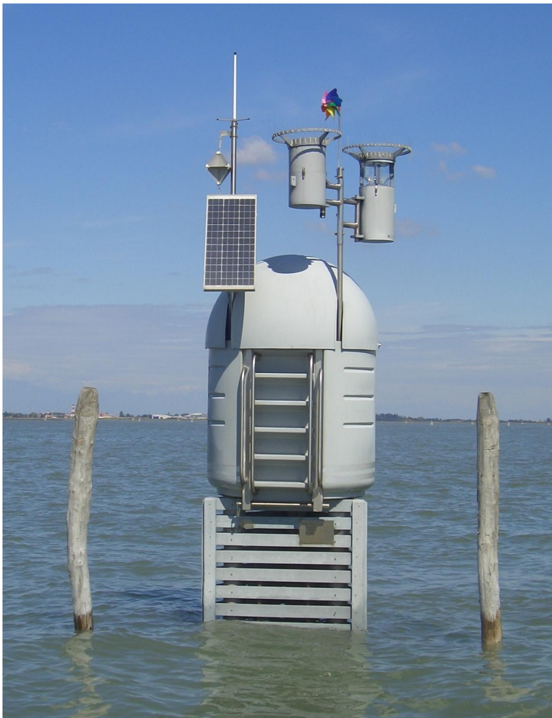
Figura 2. La stazione Ve-2 a Campalto. La stazione rileva e registra automaticamente i parametri fisico-chimici della qualità delle acque.
