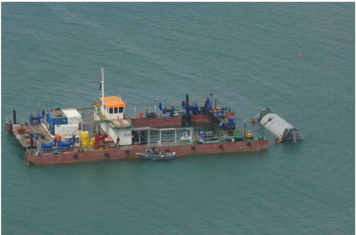
Figura8. Bocca di Lido S. Nicolò. Pontone attrezzato per il posizionamento dei materassini.
